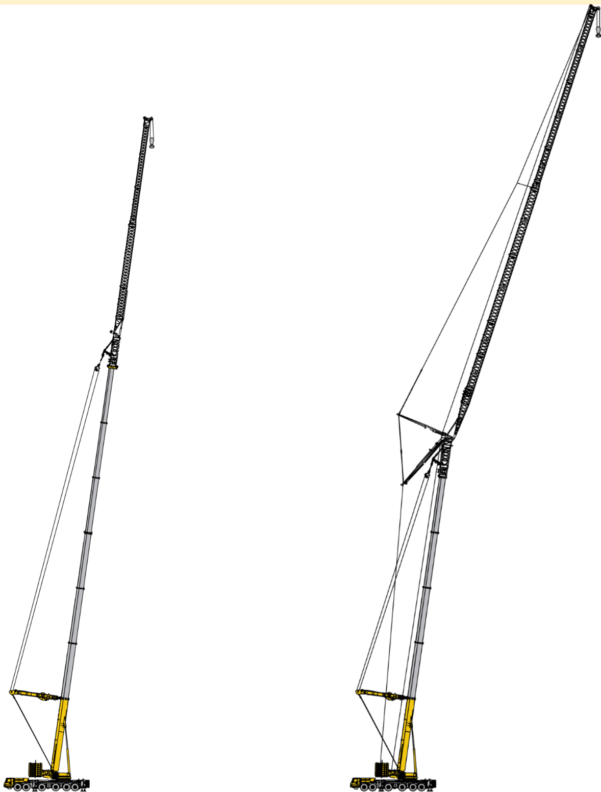
Гусек с изменением вылета и использованием суперлифта
