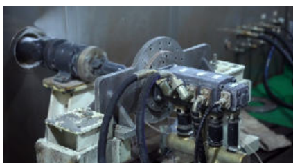
Насос рабочей жидкости гидросистемы Испытания при -40^{\circ}\text{C}
