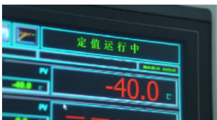
Дисплей человеко-машинного интерфейса Испытания при -40^{\circ}\text{C}
