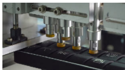
Кнопки панели 1,2 млн циклов теста на надежность
